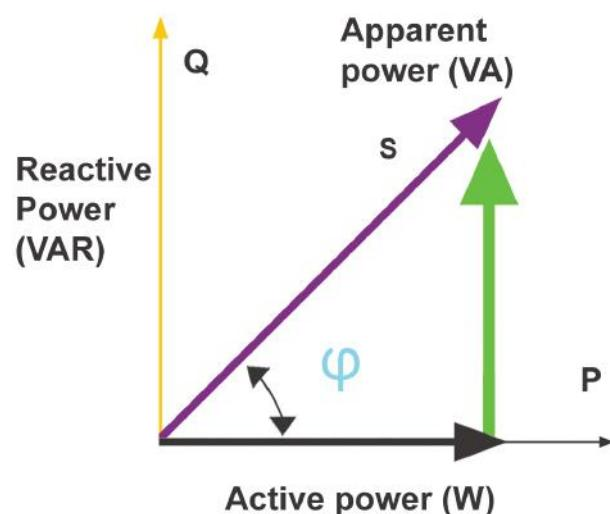
ضریب توان مقدار توان راکتیو مورد نیاز را در مقایسه با توان اکتیو نشان میدهد اگر مقدار آن 1.0 باشد نشان دهنده این است که ماشین با تمام توان موثر تغذیه ورودی کار می کند. عمولاً در ماشین های القایی مقدار ضریب توان باید بین 0.95 الى 0.85 باشد.
